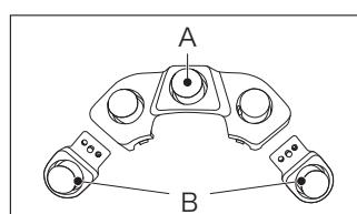
図のようにAの両サイドにBを取り付けます。
