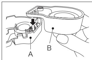
アクセサリースタンドを裏返し、Aの凸部とBの凹部を合わせ矢印の方向に押し、組み立てます。
