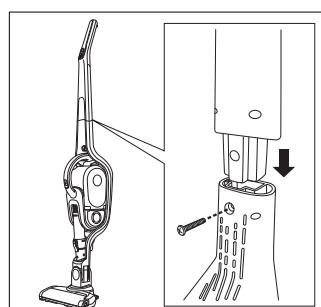
スティックハンドルを図のように矢印の方向にしっかり差し込み、付属のネジで止めてください。
