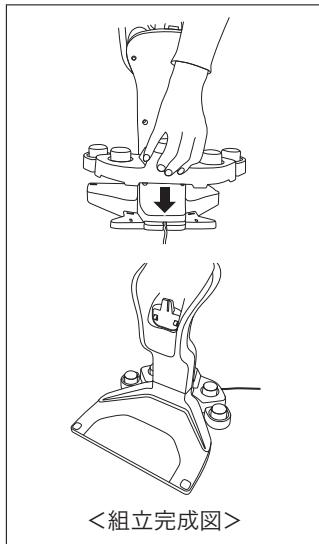
その後、アクセサリースタンドを充電台の背面に合わせ、充電台の凹凸と合わせ、上から押し、組み立てます。
