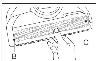
ブラシとカバーを組み立てたターボブラシも同様に図のB部分を先に凹凸を合わせ差し込み、その後C部分を下方向に力チッと音がするまで押し取り付けます。
