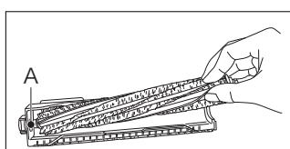
元に戻す際は、ブラシ部分のAを先に凹凸を合わせ差し込み、その後、もう片方を差し込みます。
