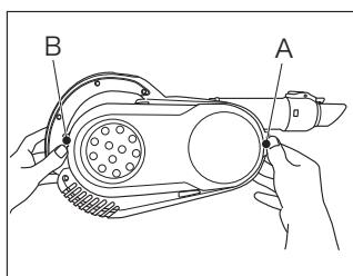
まずカバーの右側にあるタブAを本体にひっかけ、そして左側のタブBしっかりと押し込みカバーを取り付けてください。
