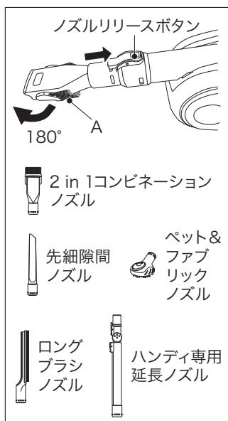
各アクセサリは図のようにハンディのフレキシブルグリップの先端に取り付けることができます。ノズルリリースボタンを押しながら差し込みます。
